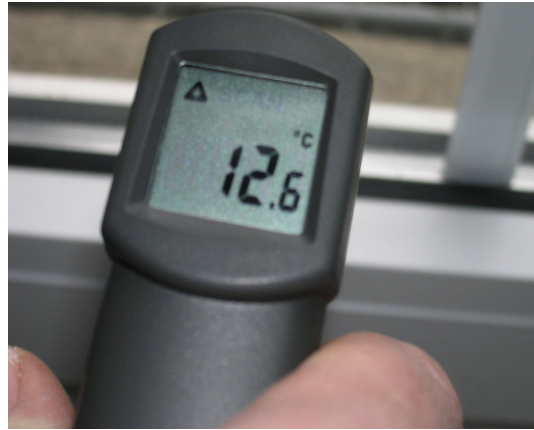
Bild 13: Beschaffung der energetischen Daten: Vor- Ort- Aufnahme zur ausführlichen Berechnung mit ROWA. Hier: Prüfung der Wärmebrücken infolge Undichtigkeiten an einem Außentüranschluss
