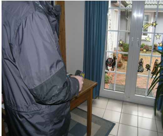
Bild 13: Beschaffung der energetischen Daten: Vor- Ort- Aufnahme zur ausführlichen Berechnung mit ROWA. Hier: Prüfung der Wärmebrücken infolge Undichtigkeiten an einem Außentüranschluss
